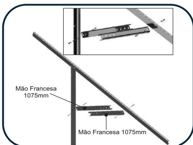
3. Detalhamento de fixação dos parafusos na mão francesa para 5°/10°/15°:
