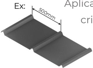
Aplicação em telhas trapezoidais com passo de entre centro de crista a partir de 255 mm. Ex: 350 mm, 475 mm, 500 mm.
