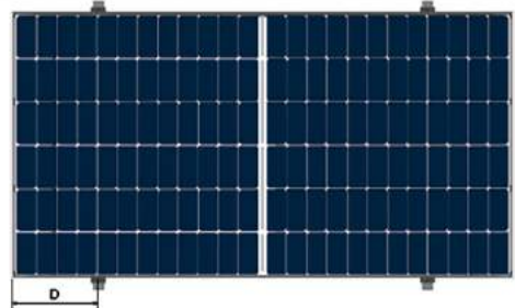
Instalação do módulo com frame com fixadores nos lados longos (barra perpendicular aos lados longos) (comprimento do clamp \geq 40\text{mm} )
