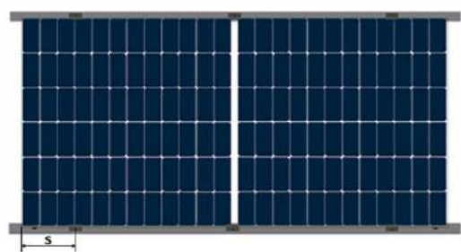
Montagem dos clamps Montagem da barra perpendicular ao lado longo do frame (comprimento do clamps \geq 40\text{mm} )
